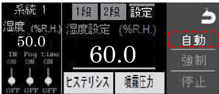
各系統別に設定した以下の噴霧開始条件が全て揃うと、対応する系統の噴霧が開始します。自動運転中は現在湿度に応じて噴霧圧力を調整します。
