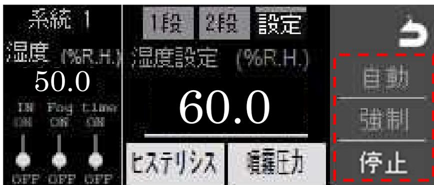
各系統の湿度設定画面横にある「自動」「強制」「停止」ボタンを押すことで装置を運転したり、停止させたりすることができます。
