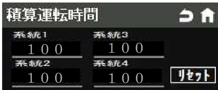
パイロット電磁弁を交換し、リセットボタンを押し、積算時間を0に戻してください。
