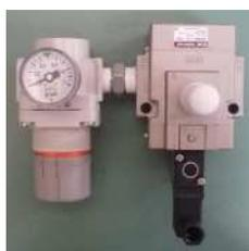
※三方電磁弁の仕様上、供給圧力が0.2MPaを下回ると弁が半開きになり、空気が排気側とノズル側に抜けます。
