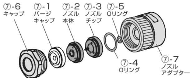
手締めで奥までねじ込んだあと、トルクレンチ(対辺24mm)を用いて1.5N・mで締め付けます。
